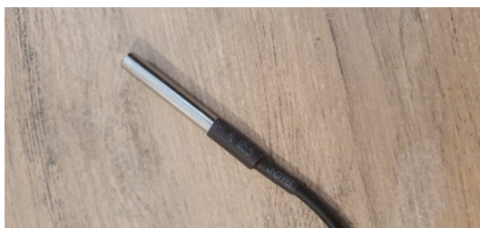
Abb.15 Wasserdichter Temperatursensor vom Typ DS18B20. 3)
